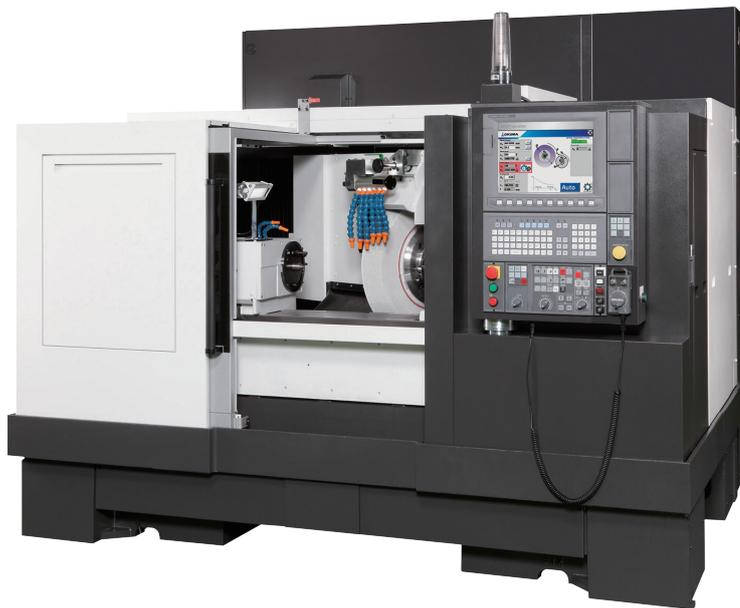
1 Schnell zu sicher hinterlegten Abrichtparametern: Wie hier auf einer Okuma-Rundschleifmaschine vom Typ GA 26 W mit OSP-Steuerung sorgt die neue Dressing App für optimale Abrichtprozesse © Okuma
